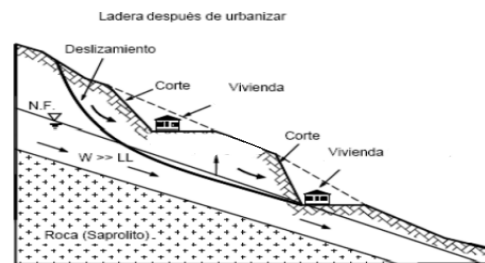
Ilustración No.3 - Ladera después de un deslizamiento
