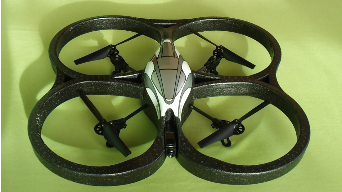
Ilustración 7. Parrot AR.Drone 1.0 con su casco protector para vuelos en espacios interiores.
