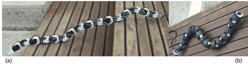
Figura 4. Desplazamientos tipo LP (a) y SW (b) del robot. 5
