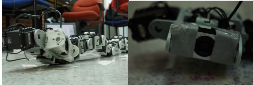
Figura 21. Ubicación lateral de la cámara en el robot, durante el movimiento de Linear Progression .
