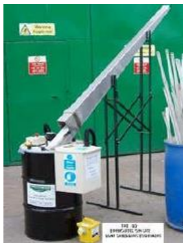
Figura 6. Equipo portátil de trituración o BulbEater, ENVIROLITE.
