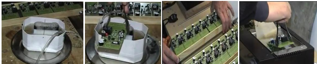
Ilustración 32 Proceso propuesto de Soldadura de circuitos por batea. Video tomado de Youtube- Soldado de circuito impreso por Batea. Realizado por Naso Tecnologis.
