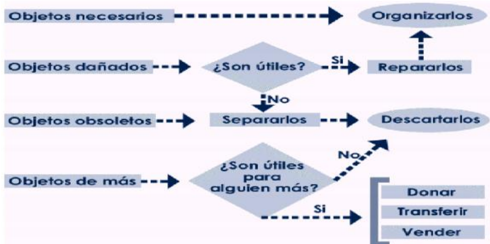
Ilustración 38 Diagrama de flujo para la clasificación. Tomado de Manual de implementación de las 5s. Corporación Autónoma de Santander. Héctor Vargas Rodríguez.
