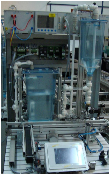
Ilustración 18 Estación de embotellado Sala CIM Fuente: (JULIANA JARAMILLO SANÍN, 2011)
