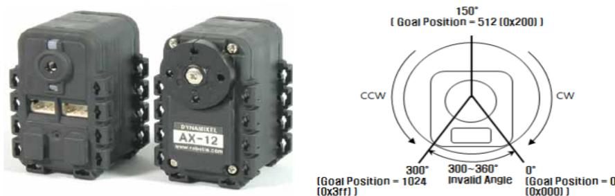
Figura 6.6: A la izquierda está el Servomotor Dynamixel AX-12. A la derecha funcionamiento del Servomotor AX-12
