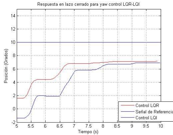
Figura 53. Respuesta de yaw lazo cerrado LQR y LQI con señal de referencia de 10 grados
