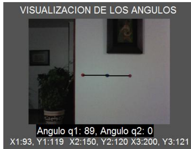
Figura 42. Visualización para los ángulos q_1 \cong 90^\circ y q_2 \cong 0^\circ para la prueba de precisión.
