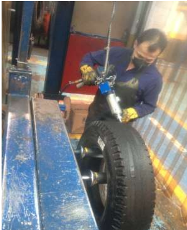
Cementado y relleno
