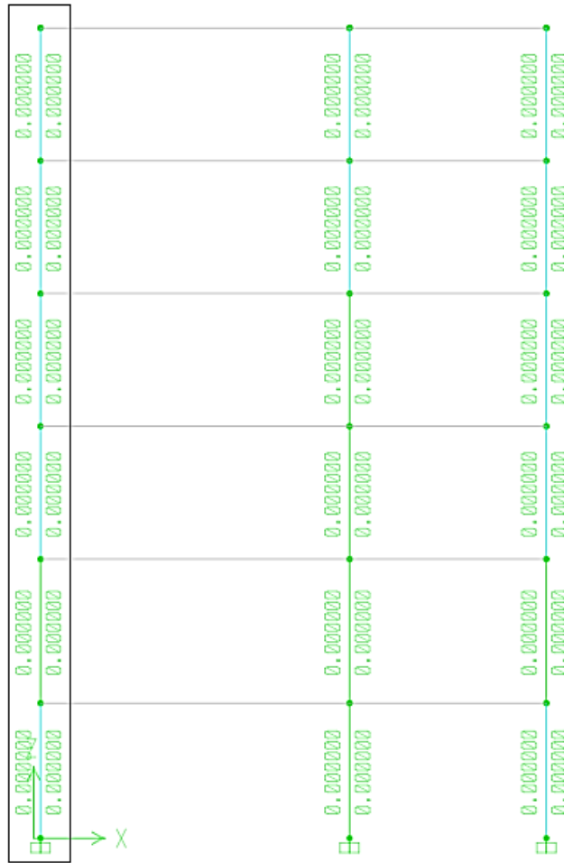
ILUSTRACIÓN 5-25. REFUERZO A CORTANTE CALCULADO POR ETABS COLUMNA C 12 - ESCENARIO 1.
