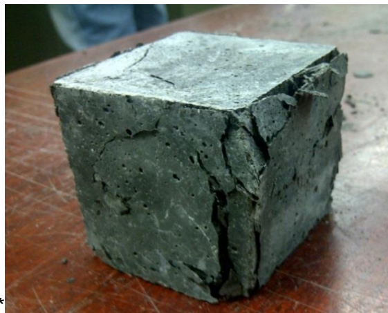
Imagen 12. Falla típica de cubo de mortero con fibras de vidrio
