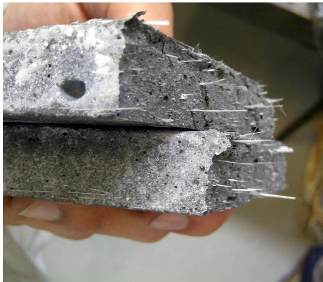
Imagen 15. Falla de probeta con fibras FG-12mm y FG-36mm
