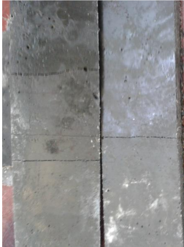
Imagen 17. Comparación en el tipo de falla entre la probeta con PVA 20 mm (Izq) y la probeta con fibra de vidrio (der).
