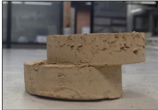
Figura 58. Falla en ensayos de corte directo
