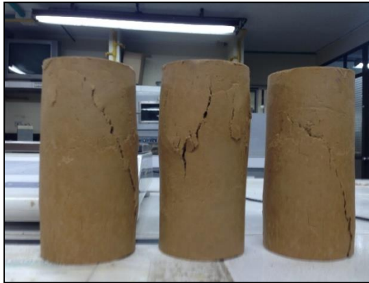
Figura 56. Forma de falla presentada en suelos cohesivos
