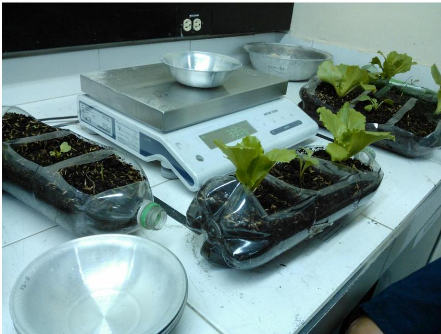
**Figura 4. Configuración de una botella de los techos verdes.**
