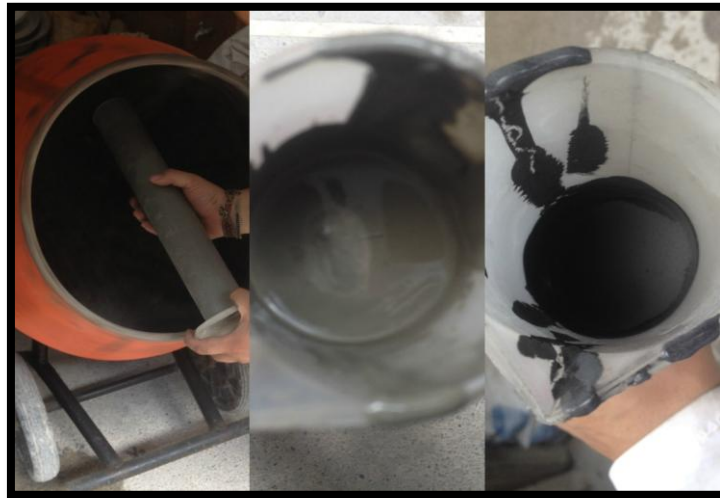
Ilustración 26, Implementación del tratamiento en el trompo (Izquierda), lechada fabricada con cemento (mitad) y lechada fabricada con humo de sílice (derecha). (Beltrán y Borrego., 2014).
