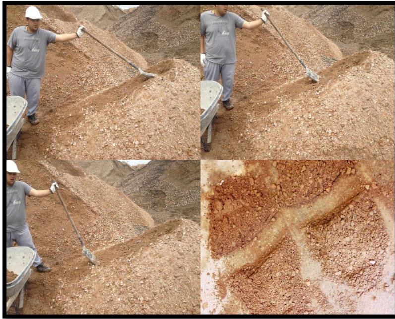
Ilustración 21 , Muestreo de las pilas tomadas arriba, en medio y debajo de la pendiente de la pila, posteriormente realización del cuarteo. NTC 129 ICONTEC., (1995). (Beltrán y Borrego., 2014).
