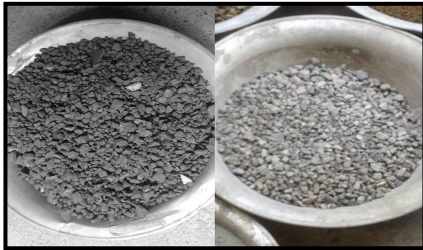
Ilustración 27, Tratamiento 5 con relación agua-cementante de 1.2, fabricado con humo de sílice (izquierda) y tratamiento 1 con relación agua-cementante de 1.2, fabricado con cemento Portland (derecha). (Beltrán y Borrego 2014).
