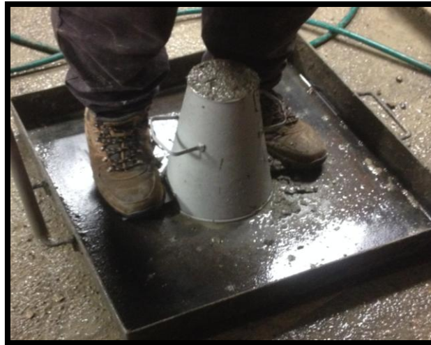
Ilustración 28, Determinación de Asentamiento. (Beltrán y Borrego., 2014)
