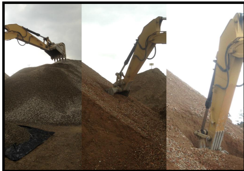
Ilustración 19. Preselección de muestras de ARE y ARC en diferentes puntos del Pilón. (Beltrán y Borrego., 2014).
