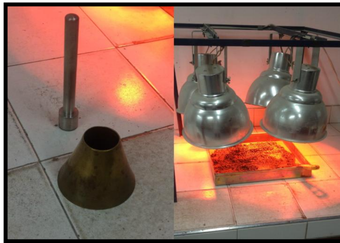
Ilustración 23, molde cónico y pisón (Izquierda), Secado superficial (Derecha). (Beltrán y Borrego., 2014).
