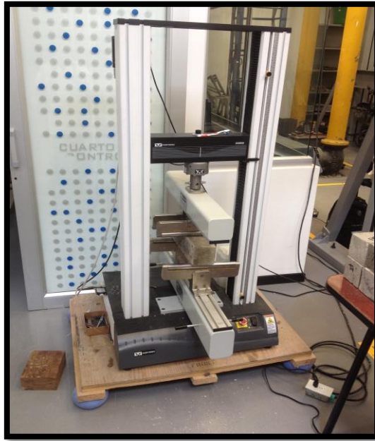
Ilustración 31, Máquina Instron 3369. (Beltrán y Borrego., 2014)
