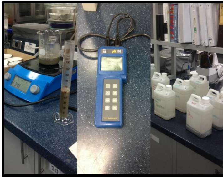
Ilustración 18, Instrumentación utilizada para los ensayos de contenido de solidos totales, Ph- Muestras recolectadas, (Beltran y Borrego., 2014).
