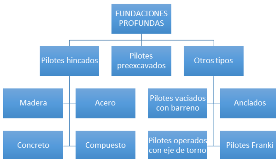
Figura 2.1: Clasificación de las fundaciones profundas tomado de Coduto (1994)
