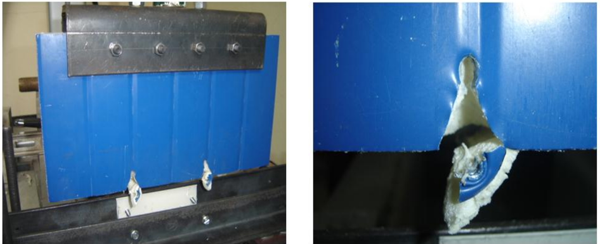
Figura 12. Mecanismo de falla de los ensayos monotónicos de las conexiones panel-remate.
