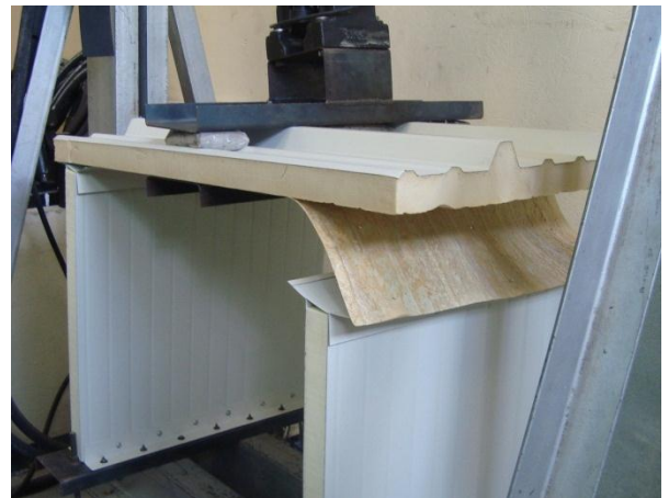
Figura 59. Falla típica sistema remache pop
