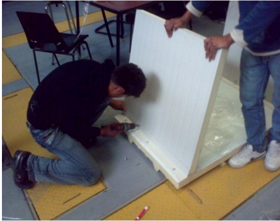
Figura 40. Montaje de las probetas por parte del personal de METECNO de Colombia
