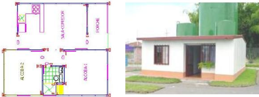
Figura 14. Plano arquitectónico de la vivienda tipo e imagen de la vivienda con el sistema METECNO de Colombia
