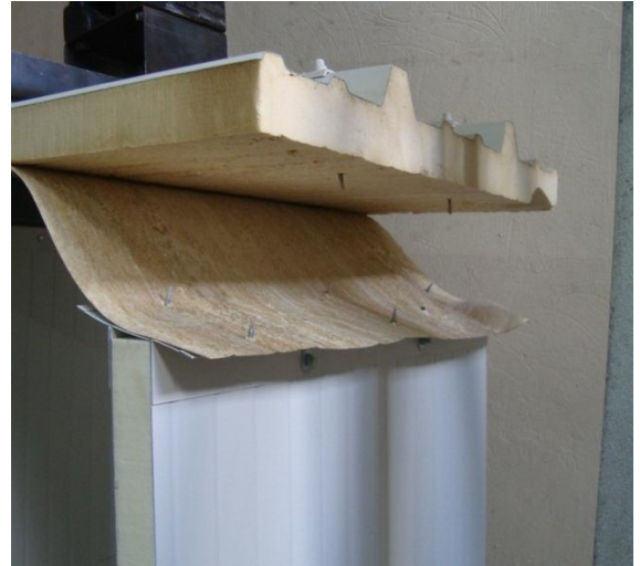
Figura 57. Falla típica sistema tornillo pasante y tornillo con capelote
