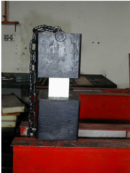
Figura 62. Ensayo de esfuerzo de adherencia de la referencia (Cimoc, 2000)
