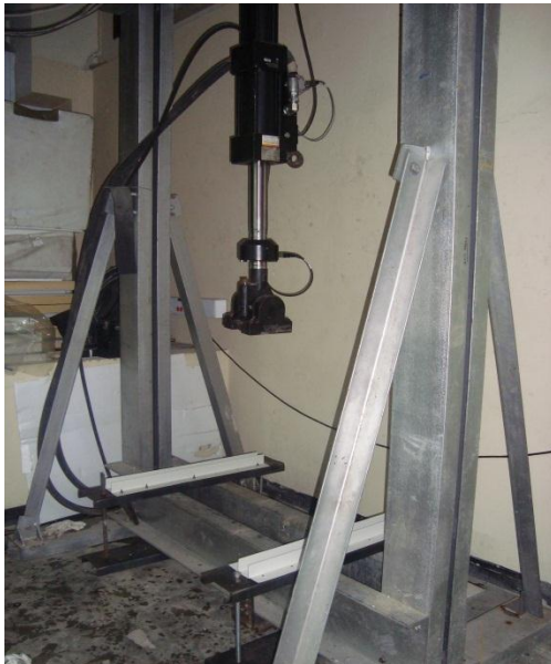
Figura 38. Aseguramiento del montaje al marco de reacción
