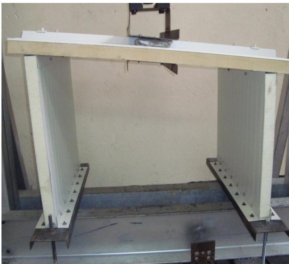
Figura 54. Sistema tradicional con tornillo con capelote
