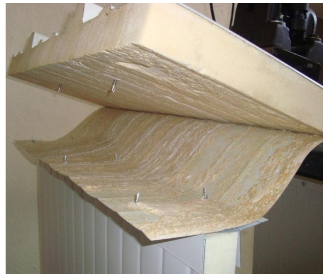
Figura 55. Falla típica sistema tradicional con tornillo con capelote
