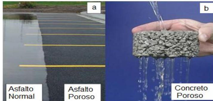
Ilustración 3: a) asfalto normal y poroso, b) concreto poroso (Fuente: Lucke et al., 2013)
