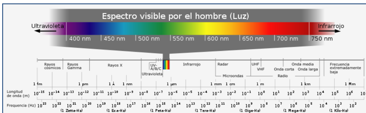
Figura 3.3. Espectro Electromagnético – Frecuencia y longitud de onda (Fuente: http://www.s-can.at/parameter.php?langcode ).
