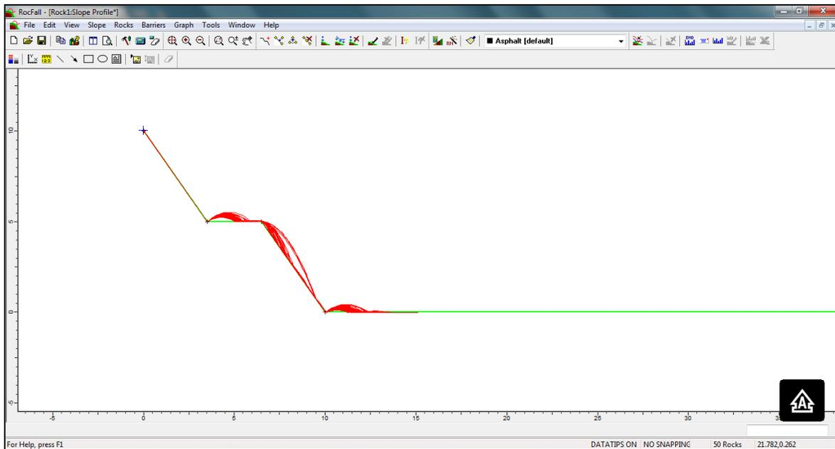
**Figura 19.** Esquema de la modelación de Rocfall para un talud de 10 m x 10 m con una berma de 3 metros.
