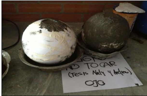
**Figura 27.** Esferas de 20 cm después de ser fundidas.
