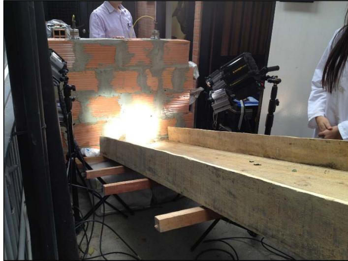
**Figura 38.** Montaje completo del muro con los acelerómetros, la cámara, luces y demás equipos.
