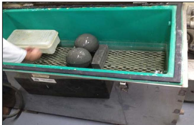
**Figura 28.** Curado de las dos esferas de 20 cm de diámetro durante 10 días en el Laboratorio de Estructuras de Ingeniería Civil.
