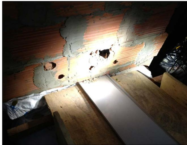
**Figura 39.** Resultado del muro luego del impacto de una de las esferas de 20 cm de diámetro.
