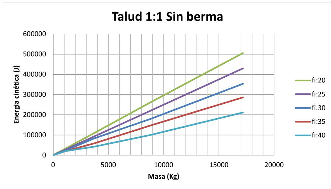
**Figura 23.** Gráfica de masa de la roca vs energía cinética para un talud de 10 metros de ancho y largo sin berma
