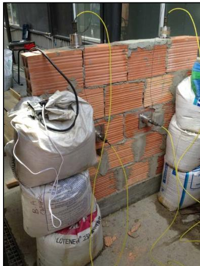
**Figura 37.** Instrumentación del muro con los cuatro acelerómetros.
