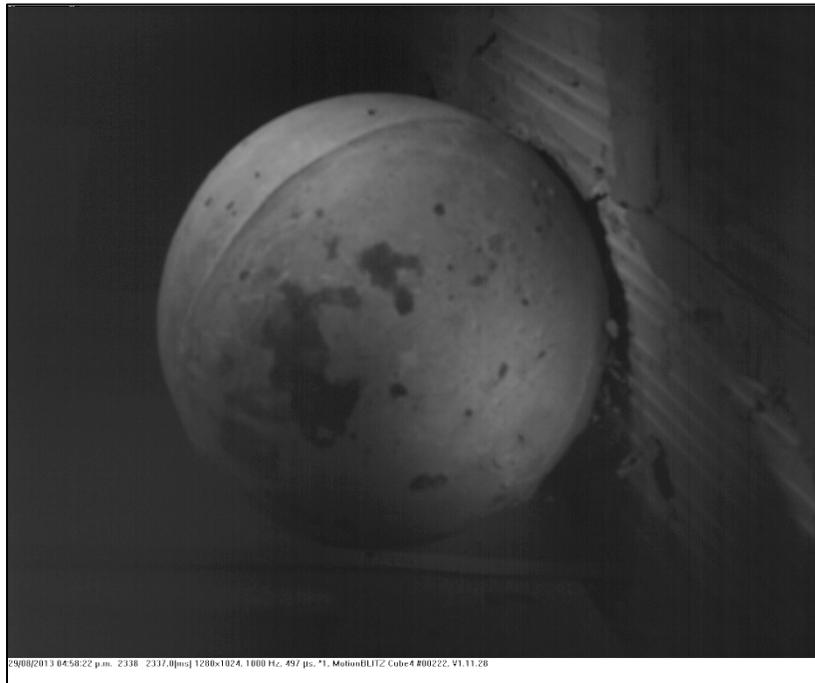
**Figura 40.** Fotografía del impacto de la esfera de 20 cm en el muro con una inclinación de 30°.
