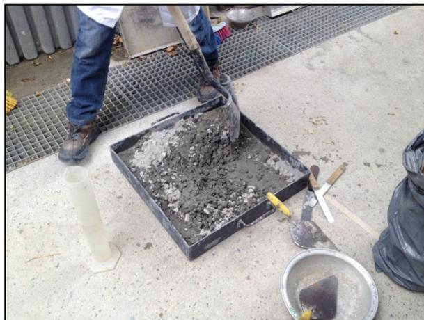
**Figura 31.** Mezcla de los materiales del concreto que conforman la viga.
