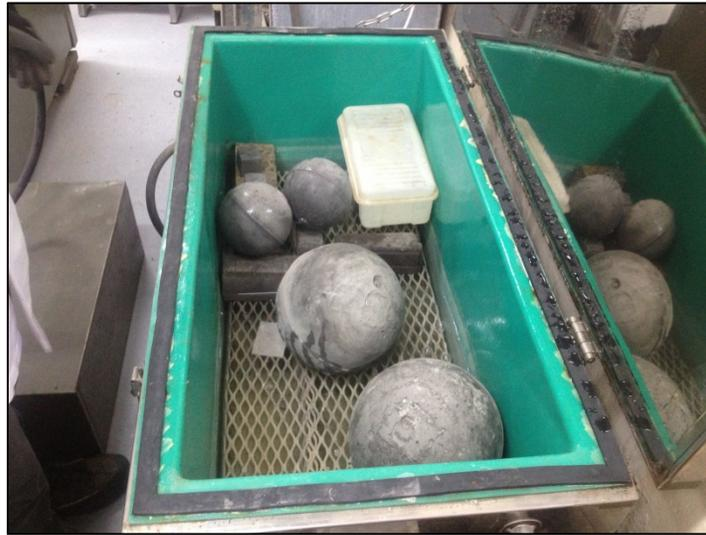
**Figura 29.** Esferas de 20 y 30 cm en la cámara de curado.
