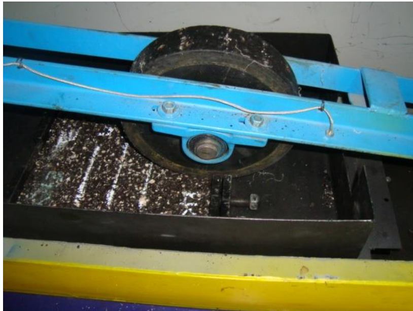
Figura 15. Ensayo de resistencia a la deformación plástica de las mezclas asfálticas mediante la pista de ensayo de laboratorio (INV 756-07)
