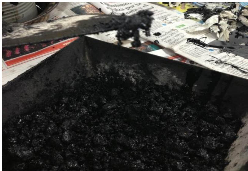
Figura 24. Grumos en la mezcla por exceso de fibra de polipropileno
