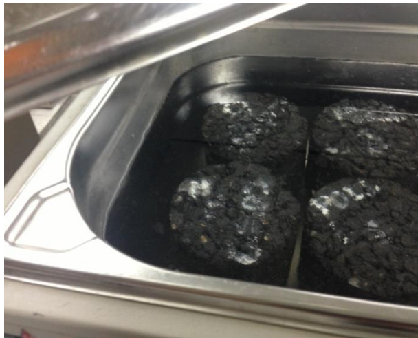
Figura 13. Especímenes acondicionados en baño de agua a 60 °C
