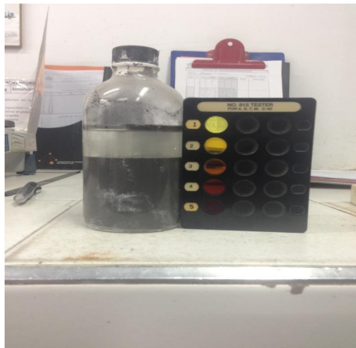
Figura 16. Ensayo de contenido de materia orgánica en la ceniza volante
