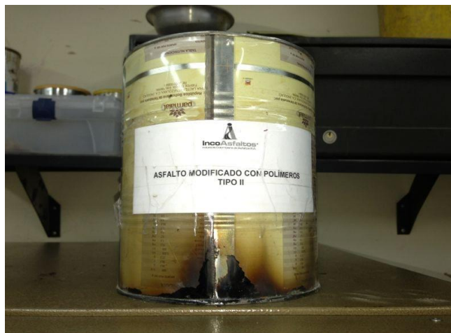
Figura 8. Asfalto modificado con polímeros tipo II
