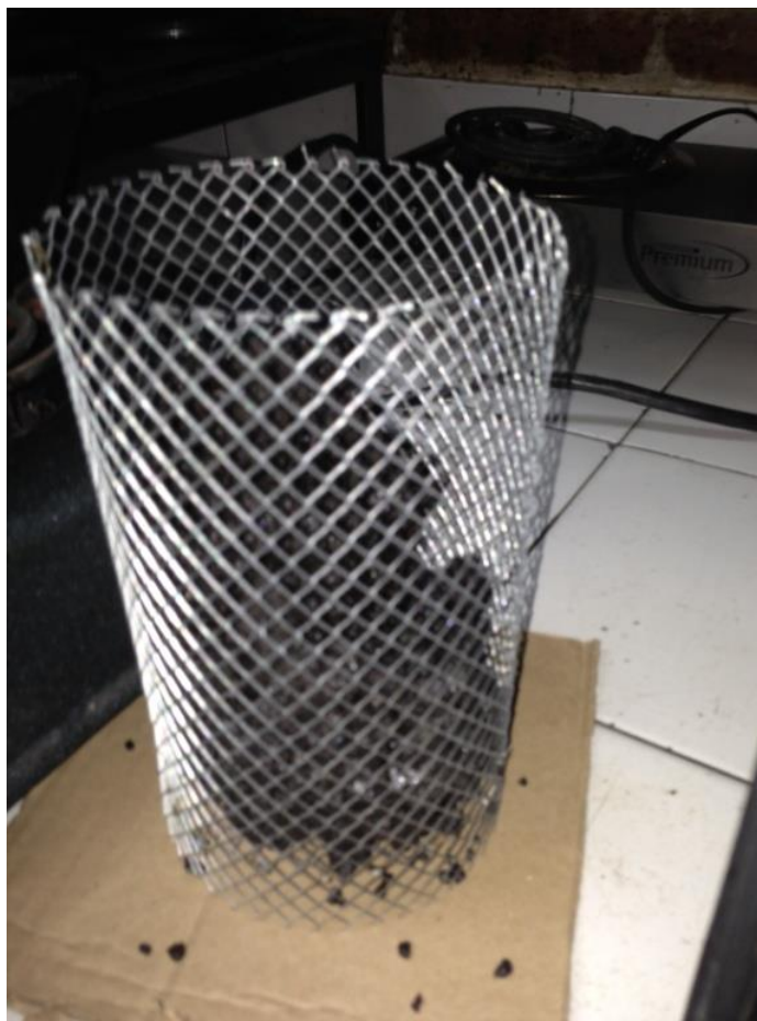
Figura 20. Ensayo de escurrimiento (AASHTO T-305)
