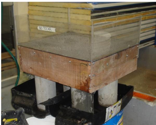
**Figura 9. Modelo físico de la capa de concreto rígido poroso y dispositivos de vertimiento y recolección (Gómez *et al.*, 2010)**
