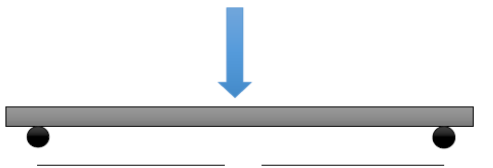
Figura 4.7: Ensayo a flexión. Diagrama de dimensiones y aplicación de carga. Vista perfil. (Mogollón, 2013)
