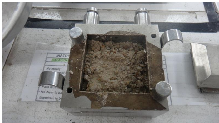
Fotografía 24. Armado de la tercera capa de material
