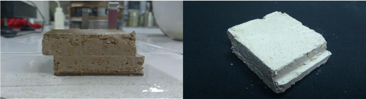
Fotografía 27. Muestra húmeda después del ensayo y secada al horno
