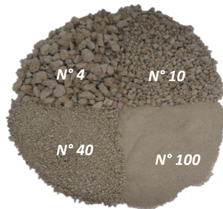
Fotografía 17. Fracciones consideradas representativas para la granulometría propuesta
