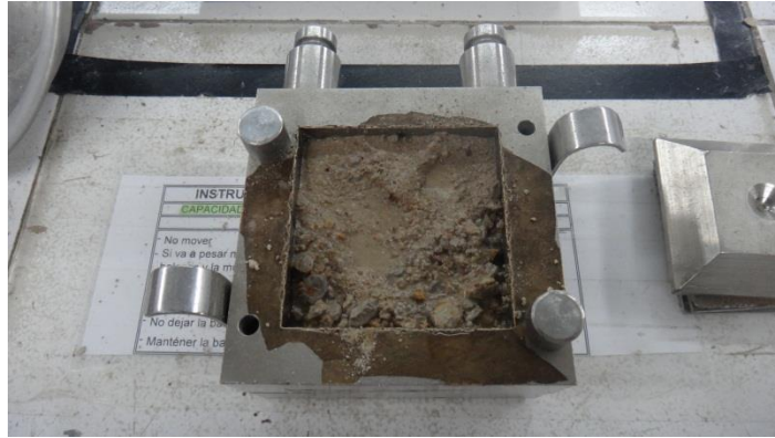
Fotografía 25. Armado de la cuarta capa de material
