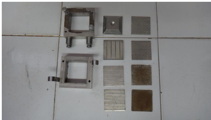
Fotografía 9. Cámara de corte cuadrada
