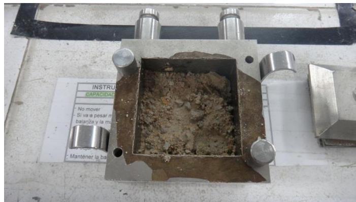
Fotografía 23. Armado de la segunda capa de material
