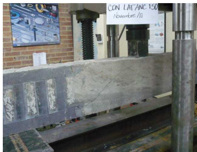
Figura 49: Viga 5A después de falla
