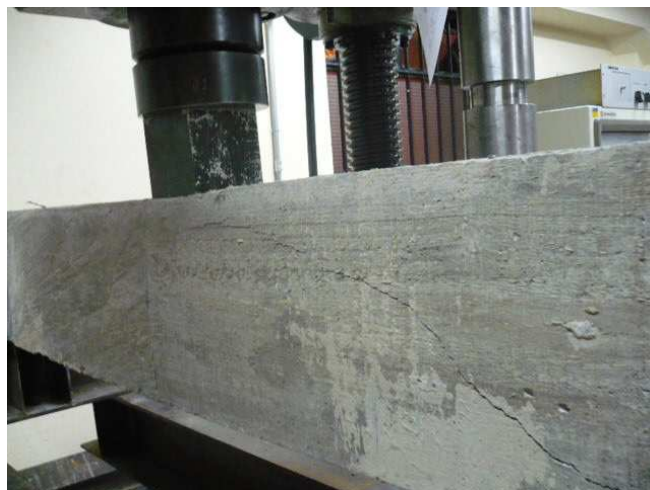
Figura 39: Viga 2B después de falla
