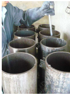
Figura 24: Elaboración de cilindros de concreto
