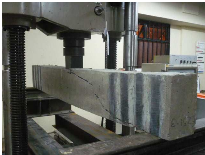
Figura 45: Viga 4A después de falla
