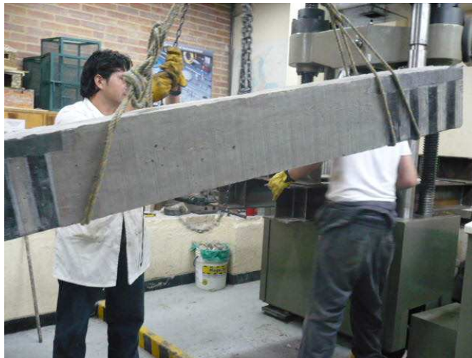
Figura 29: Posicionamiento de las vigas
