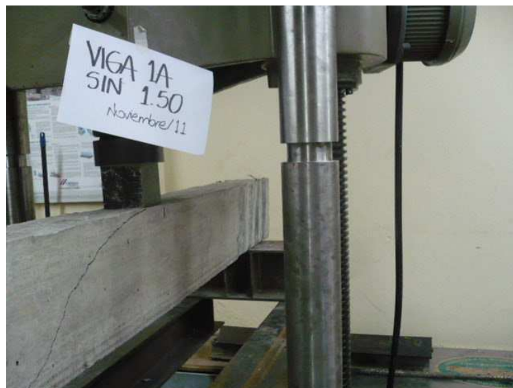
Figura 33: Viga 1A después de falla
