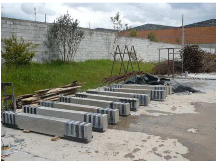
Figura 31: Vigas con diferente configuración de refuerzo
