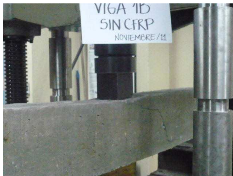
Figura 35: Viga 1B después de falla
