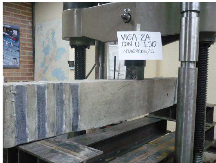
Figura 37: Viga 2A después de falla
