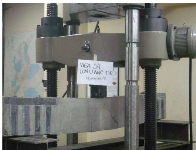
Figura 41: Viga 3A después de falla
