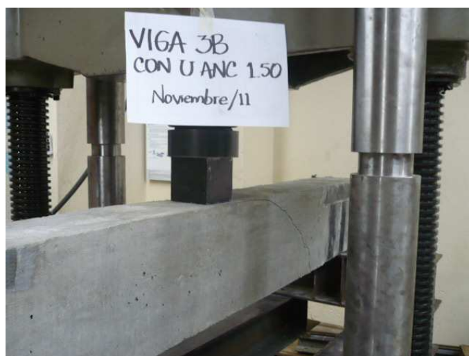
Figura 43: Viga 3B después de falla
