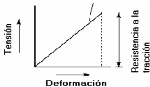
Figura 6: Curva tensión – deformación en fibra de carbono
