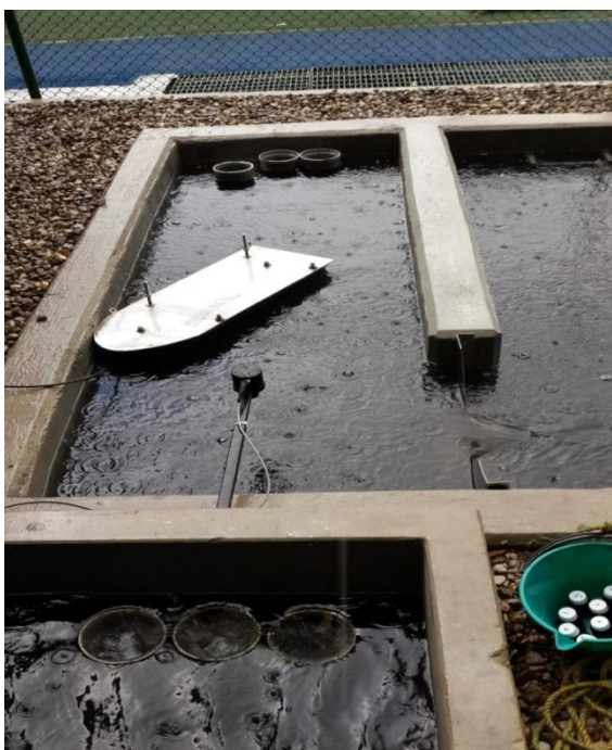
Ilustración 13. Ubicación del espectrómetro UV-Visible sobre el desarenador.
