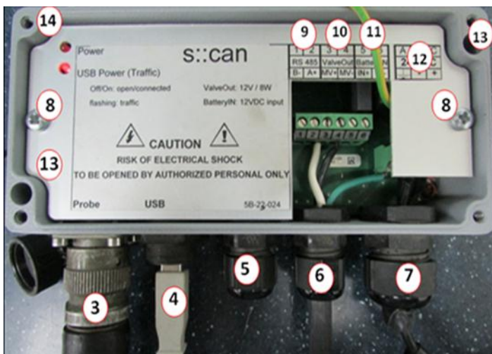
Ilustración 3. Partes Principales de un espectrómetro UV-Visible al retirar la cubierta. Fuente: Autor (2013)
