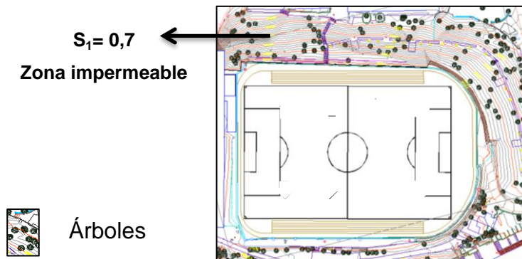
Figura 6. Esquema de área de captación y drenaje correspondiente a las zonas verdes (S: pendiente en %)
