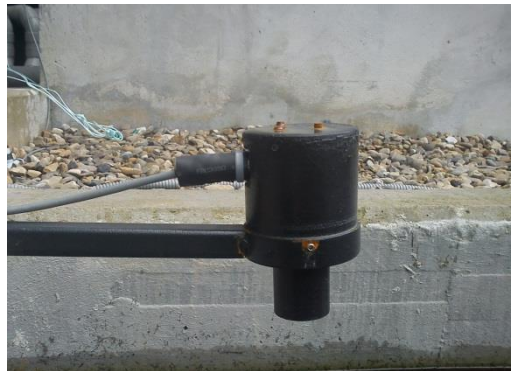
Figura 20. Montajes de sensores de nivel por ultrasonido ubicados en el sistema Humedal-Construido/Tanque-Regular
