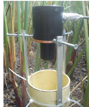
Figura 20. Montajes de sensores de nivel por ultrasonido ubicados en el sistema Humedal-Construido/Tanque-Regular
