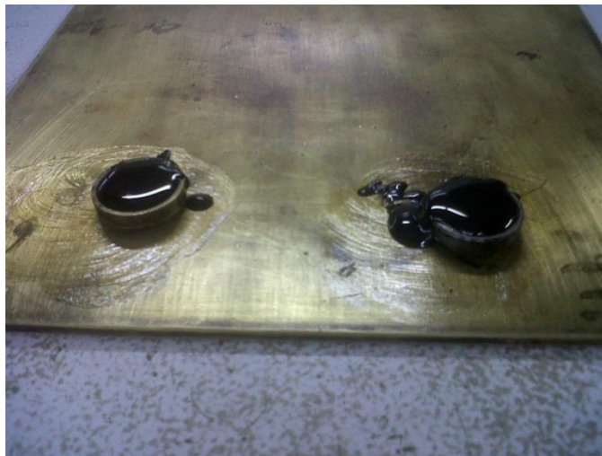
Fotografía 4 Muestras para ensayo de punto de ablandamiento según norma INV E 712-07
