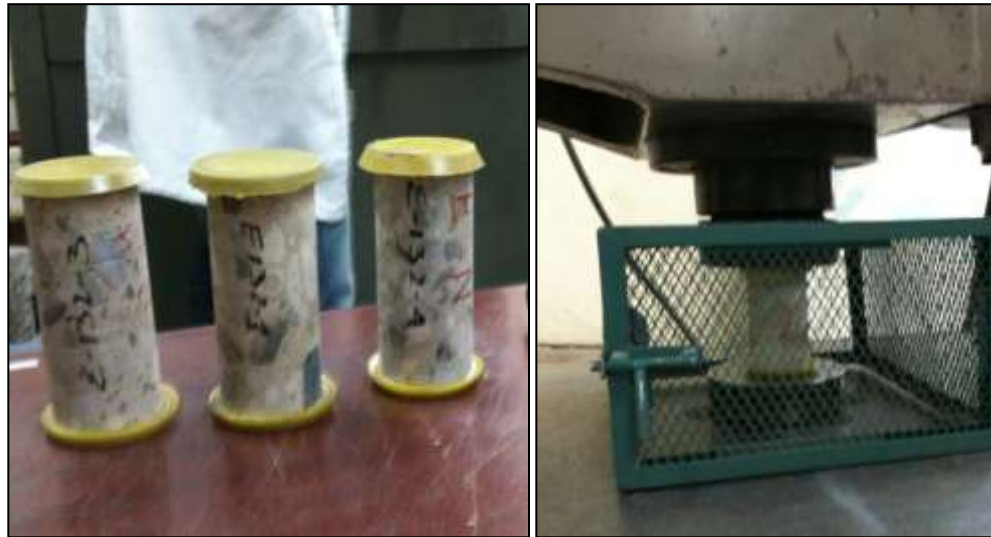
Figura 4. 8– Núcleos refrentados listos para ser ensayados.
