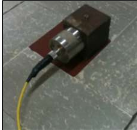
Figura 4.12 - Acelerómetro localizado en el sentido N-S del edificio [50].
