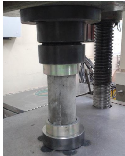
Figura 3.9 Ensayo de Resistencia a la Compresión Cilindros de Concreto
