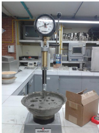
Figura 3.7 Ensayo de Tiempos de Fraguado
