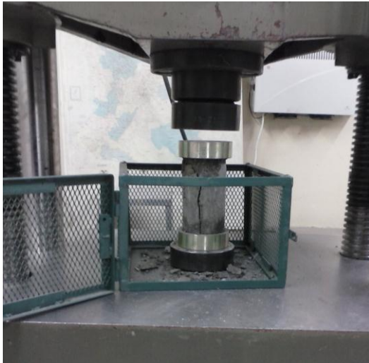
Figura 3.9 Ensayo de Resistencia a la Compresión Cilindros de Concreto
