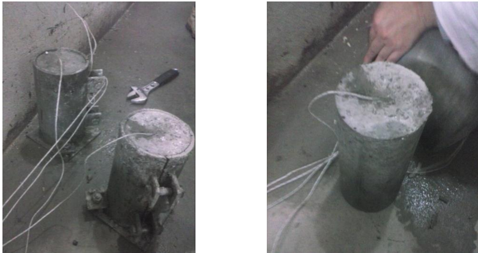
Figura 3.17 Instrumentación en cilindros
