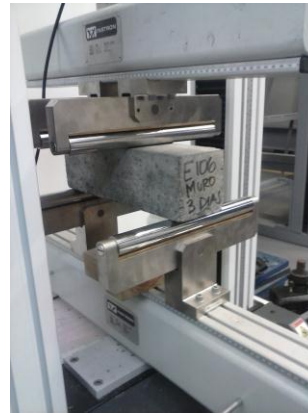
Figura 3.11 Montaje Ensayo de Resistencia a la Flexión en Vigas de Concreto
