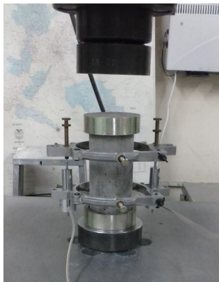
Figura 3.13 Montaje ensayo de módulo de elasticidad en cilindros de concreto
