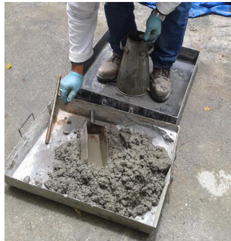
Figura 3.5 Ensayo de asentamiento
