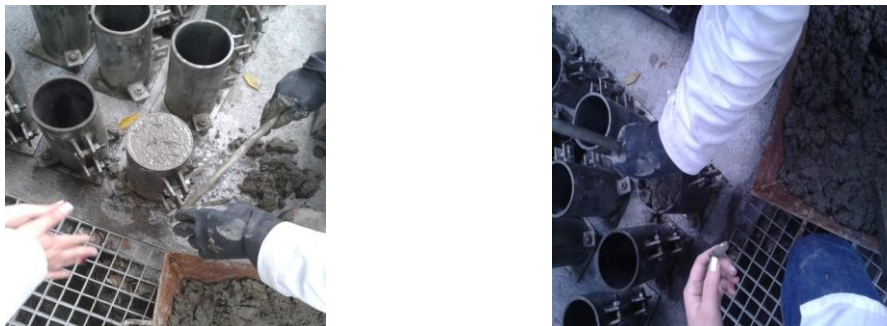
Figura 3.8 Fabricación de Cilindros de Concreto
