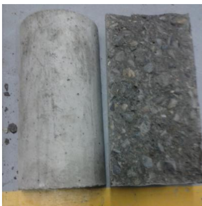
Figura 4.8 Falla por Tracción Indirecta.
