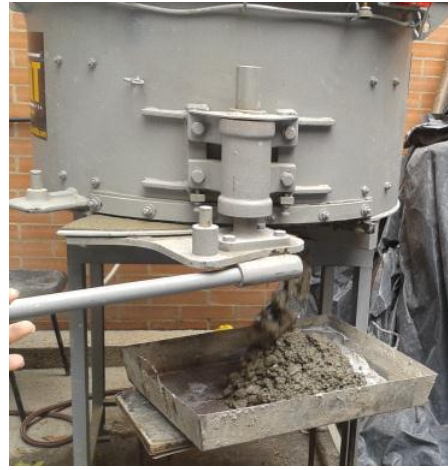
Figura 3.4 Mezcladora Domat 150 litros – Universidad Javeriana
