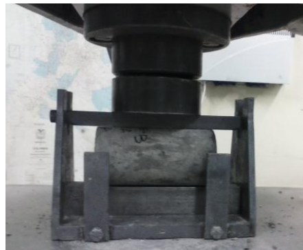
Figura 3.10 Montaje Ensayo de Resistencia a la Tracción Indirecta Cilindros de Concreto
