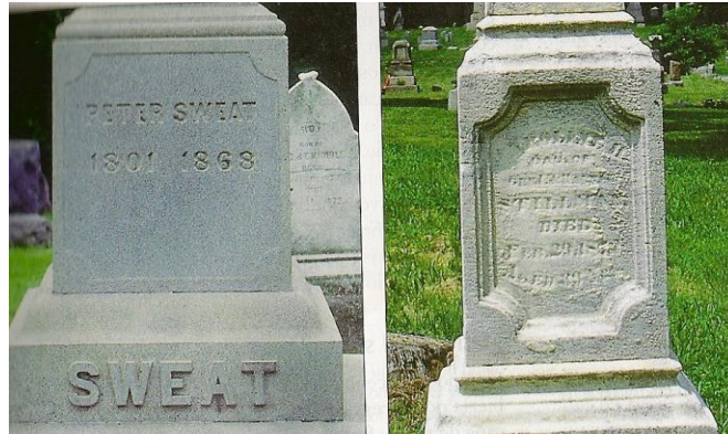
Gráfica 2.31 El examen de las lapidas revela la velocidad de meteorización química en diversos tipos de roca (Tarbuck & Lutgens, 2005)
