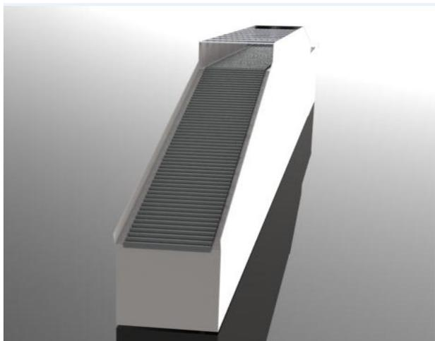
Iniciando el proceso de lavado, un empleado se encarga de descargar los bultos de papa que vienen en el camión del proveedor. El bulto es abierto por la parte superior y es vaciado sobre la primera banda de cilindros. Los cilindros se mueven por medio de un motor de 2.5 caballos de fuerza ubicado en la parte inferior de la estructura.
