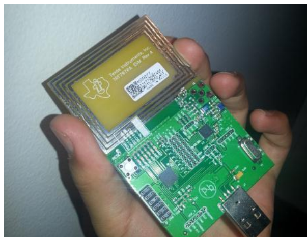
Ilustración 42. Manipulación de la tarjeta sin manilla con descarga a tierra.
