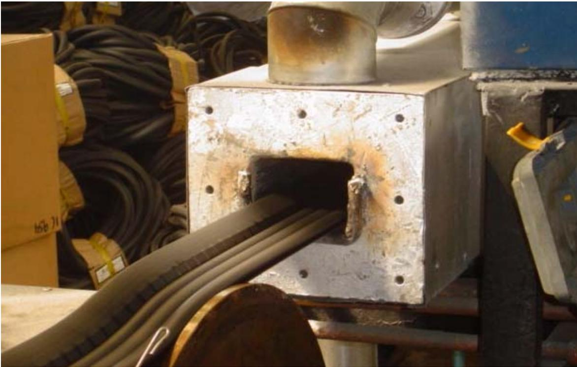
**Figura 7. túnel de vulcanización**
