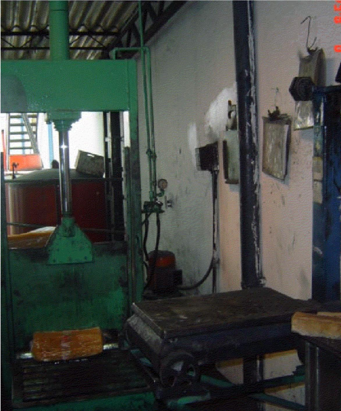
**Figura 5. Cortadora de caucho y báscula**
