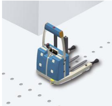
Ilustración 10. Sistema de guiado magnético
