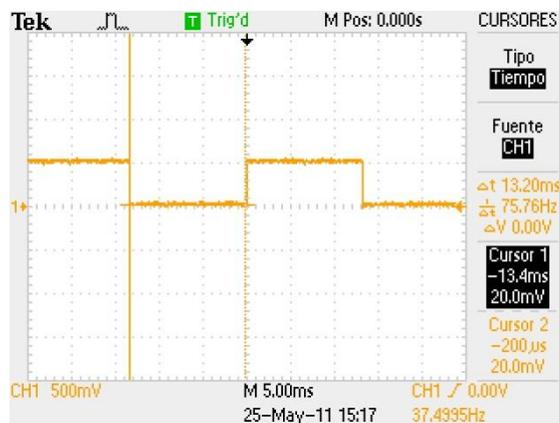
Figura 24 Frecuencia de muestreo 75Hz
