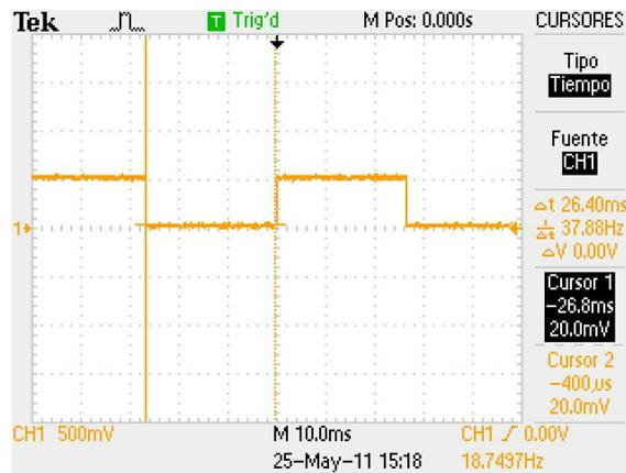
Figura 25 Frecuencia de muestro 37Hz
