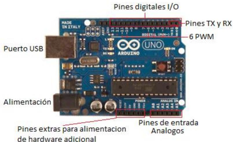
*Figura 1.42. Placa Arduino Uno implementada como Maestro del sistema Hexápodo (tomado de [42])*
