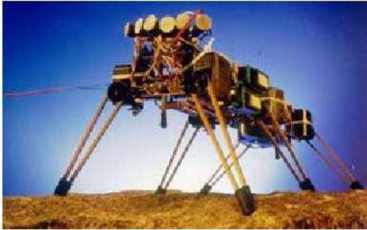
*Figura 1.2. Hexápodo de un grado de libertad. (Tomado de [8])*
