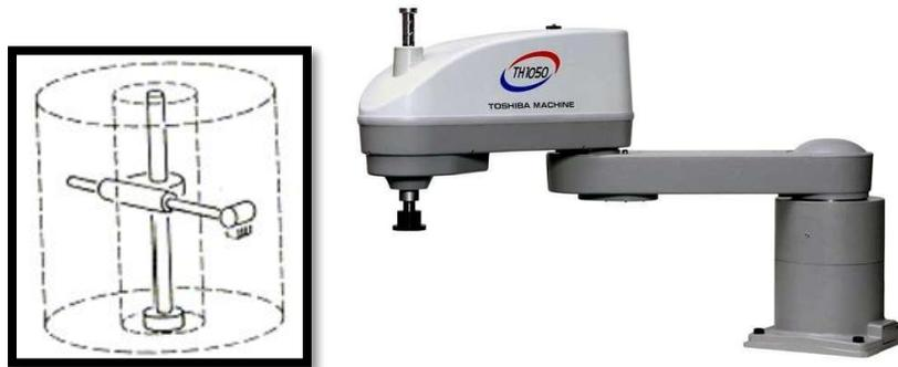
*Figura 1.15 Volumen de trabajo cilíndrico (izquierda) .Robot SCARA (derecha ejemplo robot con volumen de trabajo cilíndrico) (Tomado de [16] [18])*
