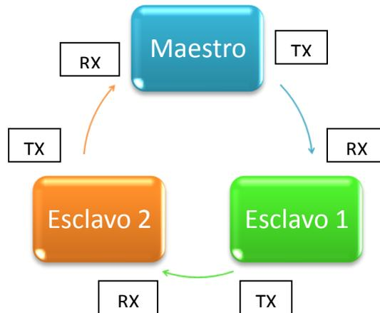
Figura 1.51 Diagrama de bloques protocolo de comunicación, Red en anillo
