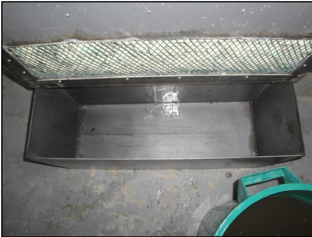
Figura 3 - 11 Dispositivo aforador, a la salida del modelo.
