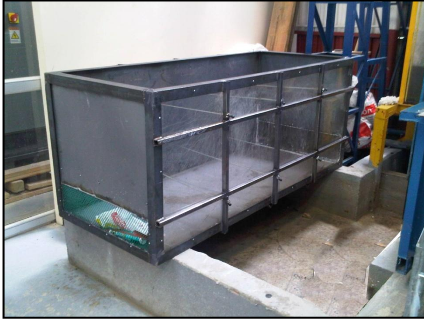
Figura 3 - 9 Modelo de trinchera de retención.
