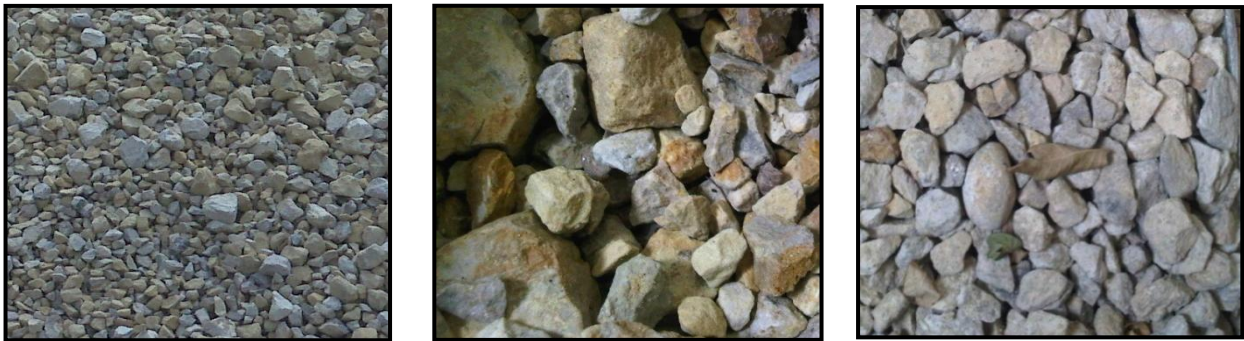
Figura 3 - 12 De izquierda a derecha: grava No. 1 (10 mm a 80 mm), No.2 (20 mm a 80 mm) y No. 3 (25 mm a 50mm)
