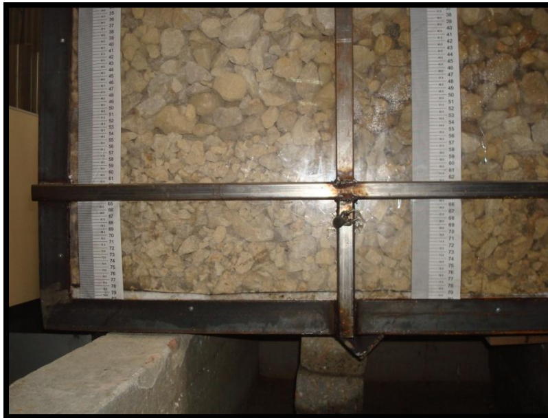
Figura 4 - 36 Deterioro del modelo de trinchera de retención de laboratorio
