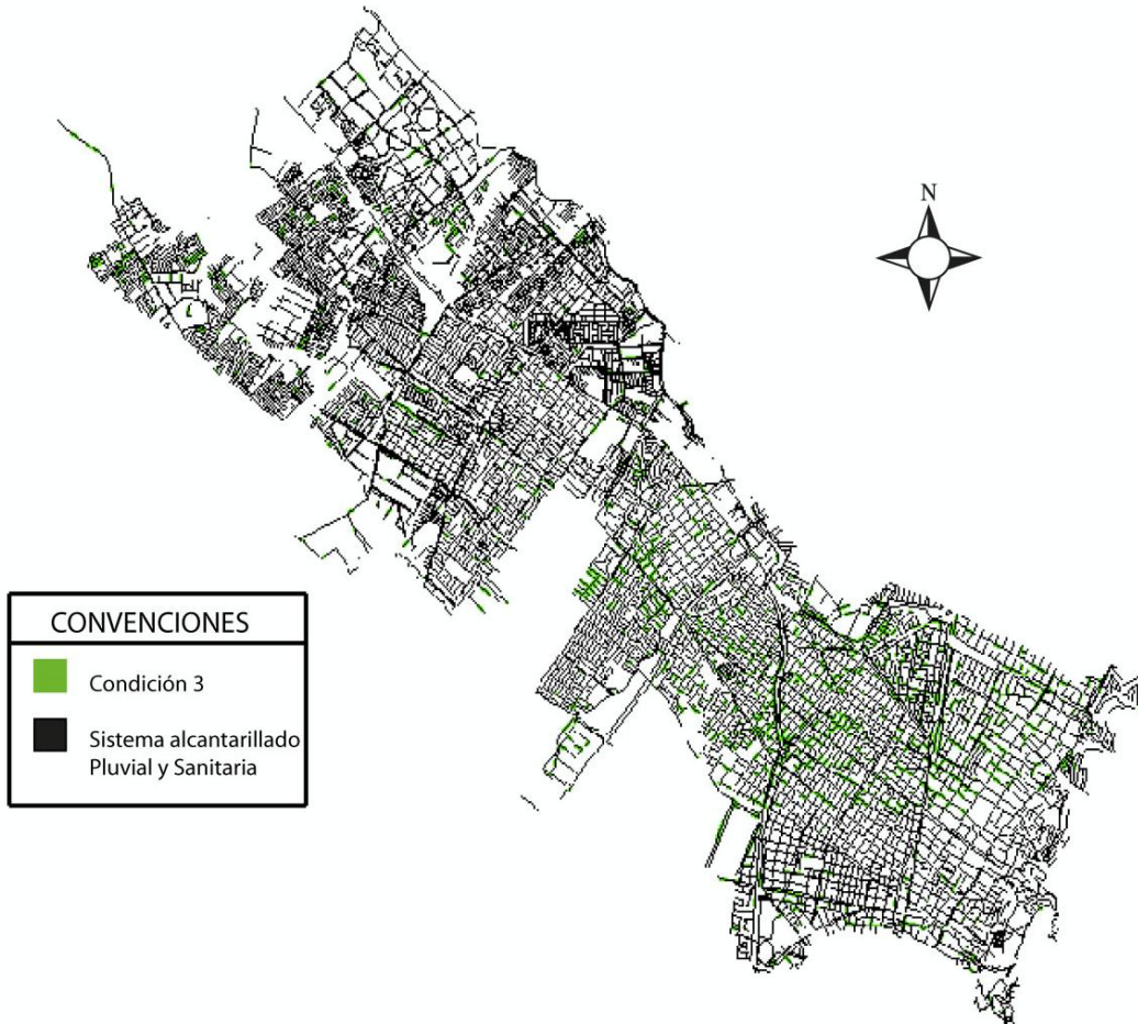
Figura 11. Tuberías con Condición 3 actual
