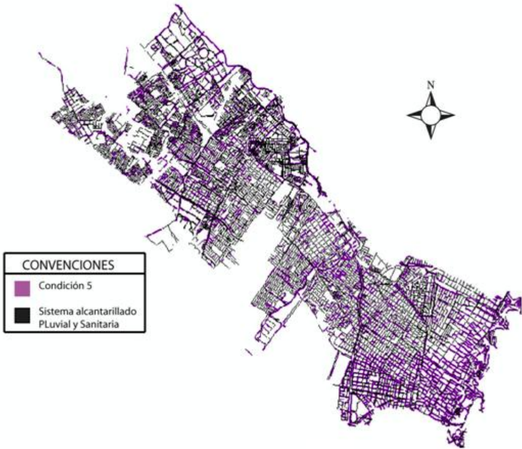
Figura 13. Tuberías con Condición 5 actual
