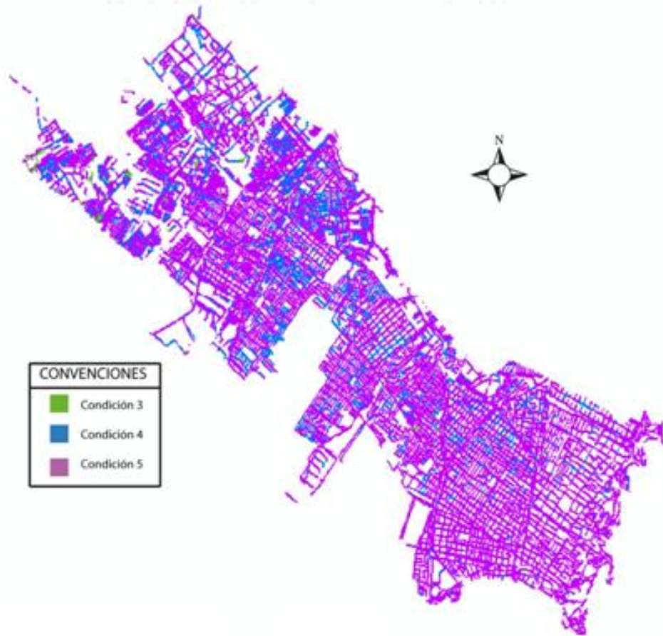
Figura 19. Condición actual tuberías año 2008
