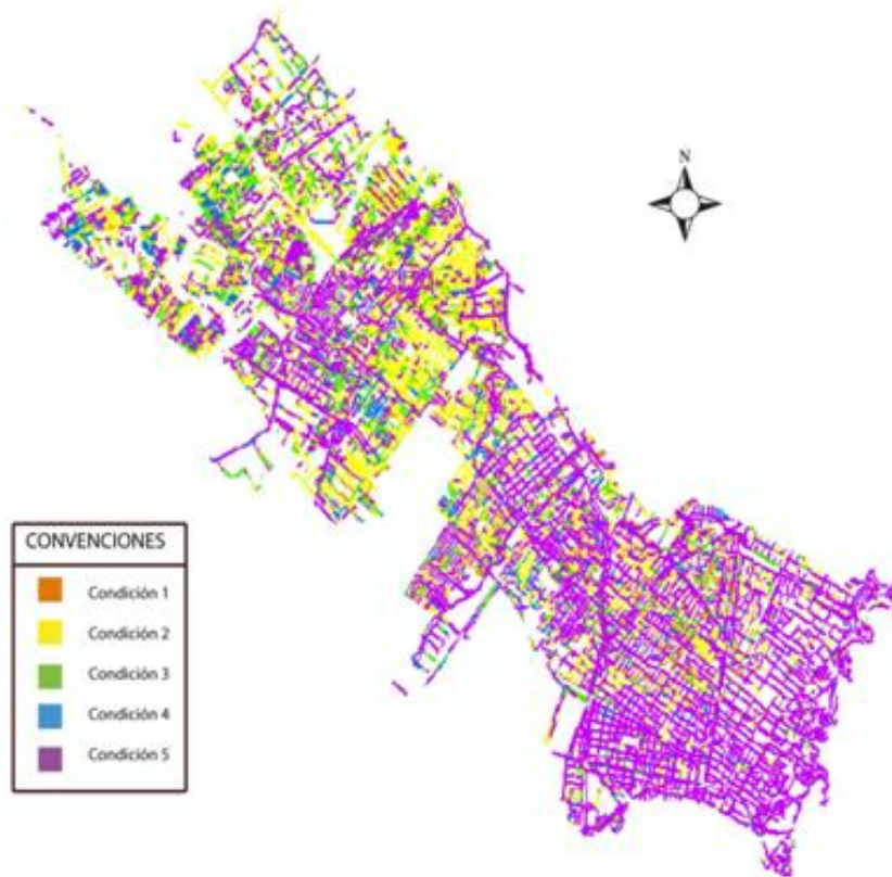
Figura 15. Condición actual tuberías año 2004
