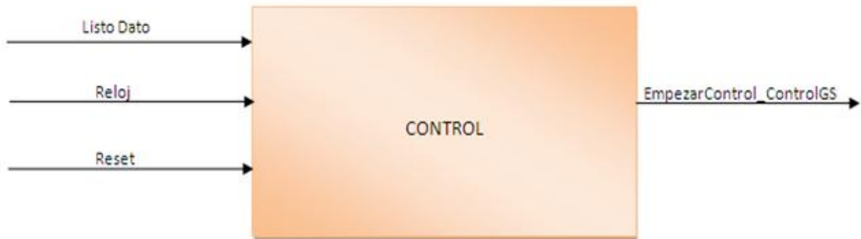
Figura 26: Entradas y salidas del sistema de Control.
