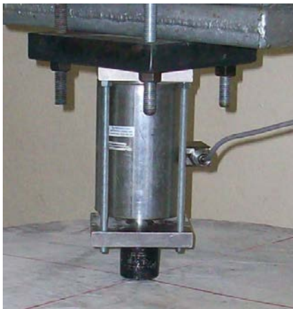
Ilustración 28 – Celda de carga empleada en ensayos de placa circular
