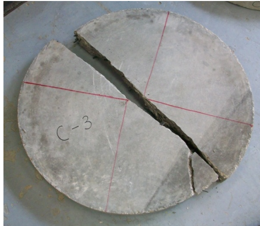
Ilustración 35 – Falla probeta circular C3
