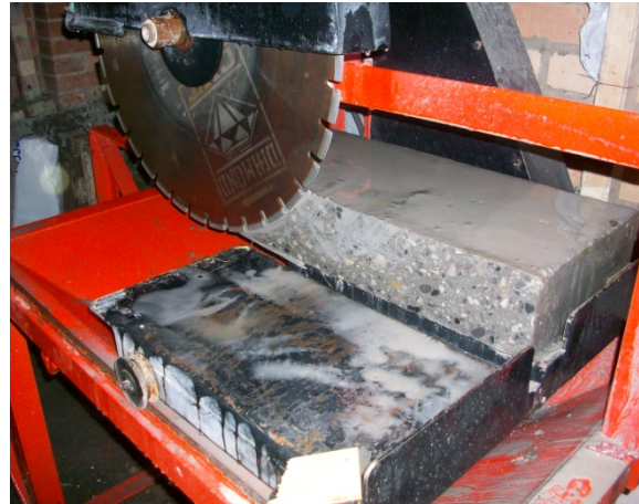
(b) – Proceso de corte de placa cuadrada
