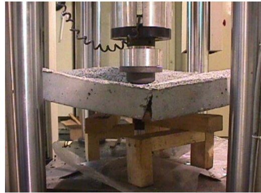
Ilustración 14 – Probeta circular adicionada con fibras sintéticas (Canals i Llopart, 2002)
