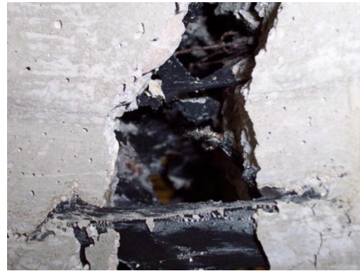
Ilustración 27 – Resultado de ensayo de viga UNI 12390 (Aiello & Leuzzi, 2010)
