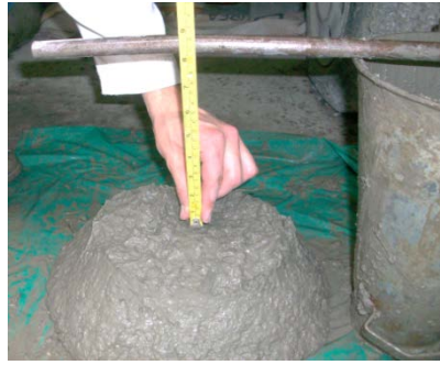
(b) – Asentamiento mezcla con fibras 1 (20.3 cm)
