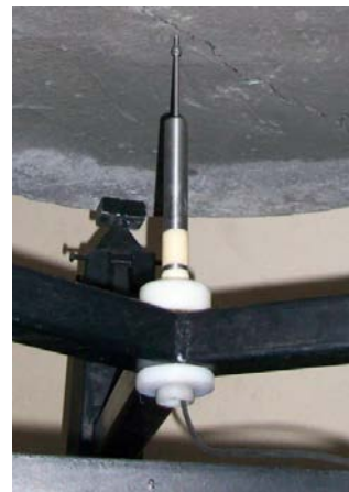
Ilustración 29 – Deformímetro empleado en ensayo de placa circular
