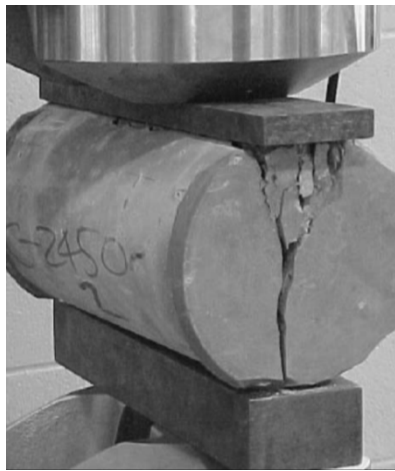
Ilustración 5 – Ensayo de tensión indirecta (Li, Stubblefield, Garrick, Eggers, Abadie, & Huang, 2004)
