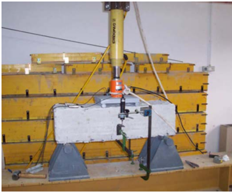
Ilustración 27 – Resultado de ensayo de viga UNI 12390 (Aiello & Leuzzi, 2010)
