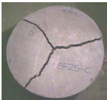
(a) – Probeta adicionada con fibras metálicas (3 grietas radiales, falla ideal)
