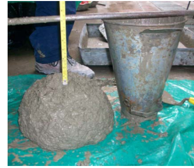
(c) – Asentamiento mezclas con fibras 2 (17.8 cm)
