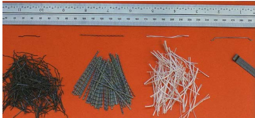
Ilustración 7 – Macrofibras, ejemplos de geometrías (Sika S.A., 2010)
