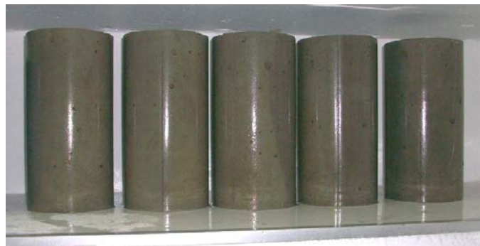
(b) – Cilindros en cámara de curado
