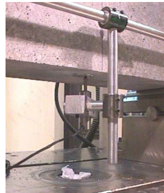
Ilustración 18 – Montaje de ensayo de resistencia flexural y tensión residual en vigas (Canals i Llopart, 2002)
