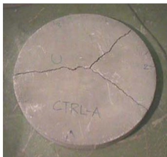
(b) – Probeta sin adición (3 grietas radiales)
