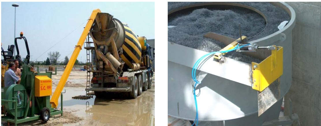
Ilustración 10 – Dosificación automática de fibras (Marson Franco, 2010)
