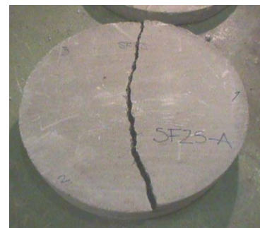
(c) – Probeta adicionada con fibras metálicas (2 grietas radiales)
