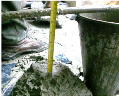
(a) – Asentamiento mezcla con caucho (16.5 cm)
