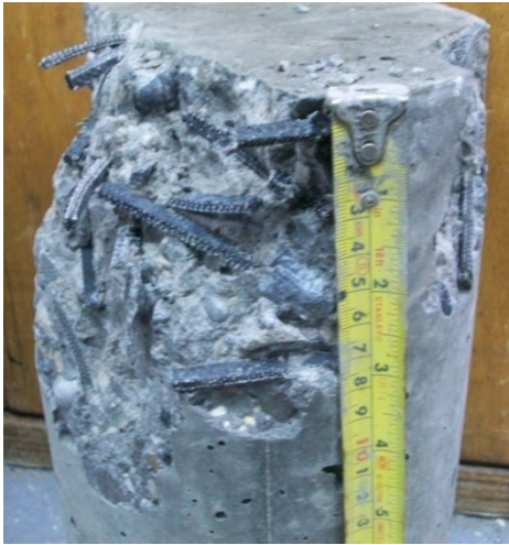
Ilustración 40 – Falla típica cilindro de concreto adicionado con caucho
