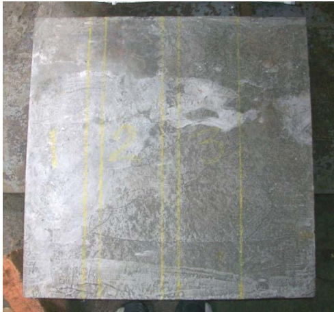
(a) – Placa cuadrada previa al corte de vigas
