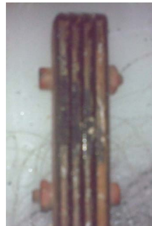
Ilustración 22 – Troquel empleado para el corte de las tiras de caucho
