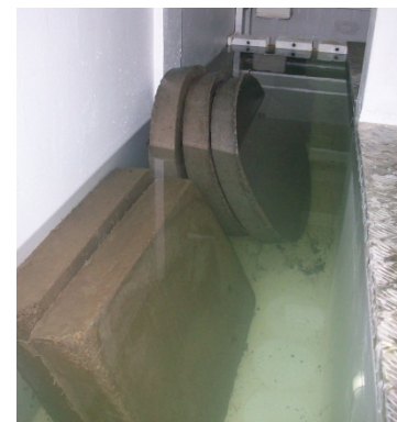
(b) – Cilindros en cámara de curado
