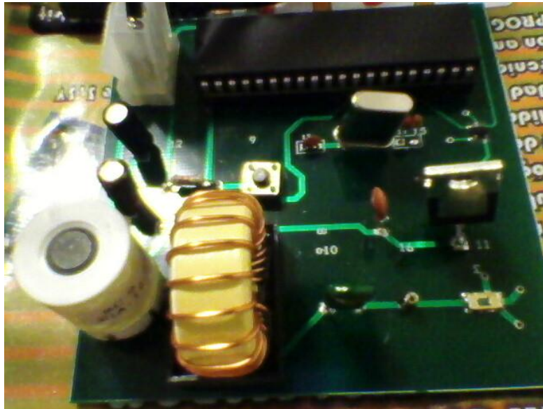
Figura 39: Foto del PA Clase-E sobre PCB.
