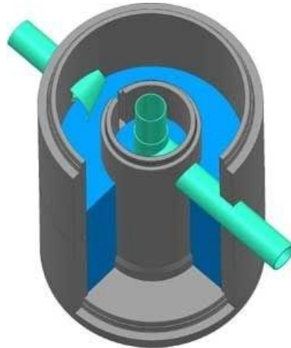
Figura 9. Esquema de un filtro para el tratamiento de agua (Direct Industry 2011)
