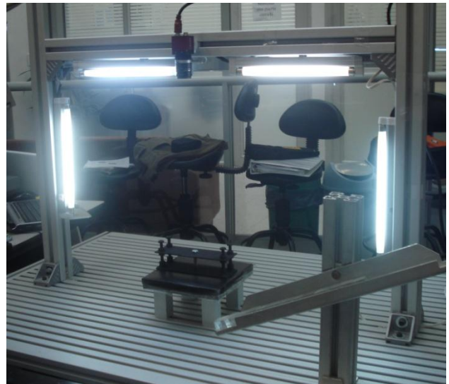
Imagen 7-8 Posición de las cámaras en el montaje de captura Fuente: Presentación propia de los autores
