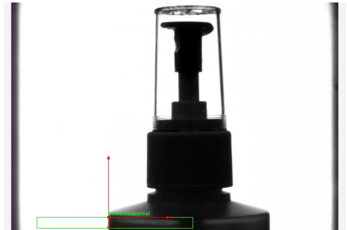
Imagen 5-10 Posicionamiento del Eje de Coordenadas Fuente: NI Vision Builder for Automated Inspection Tutorial
