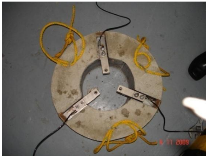
Imagen 5.7: Anillo con Celdas de Carga tipo LOADTRON en Laboratorio.
