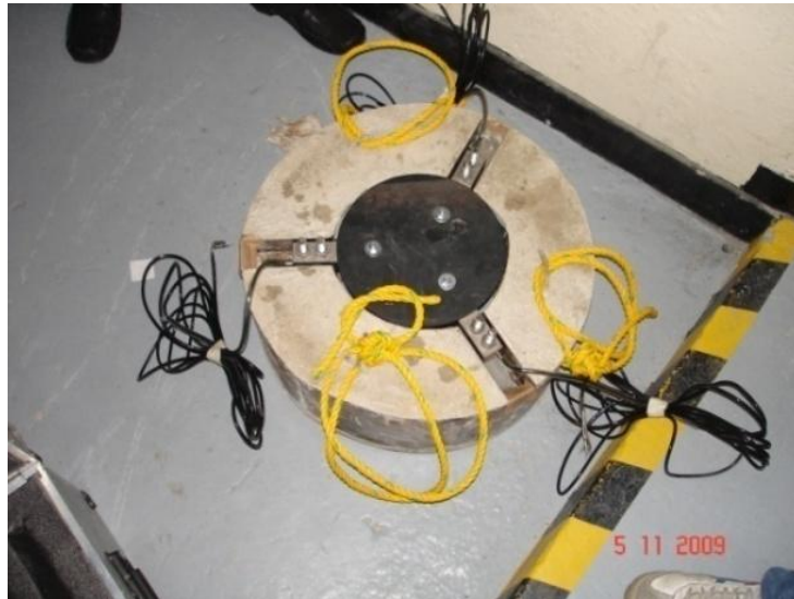
Imagen 5.8: Montaje final de las celdas de carga.
