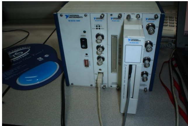
Imagen 6.4 Módulo de conexión NI-SCXI-1520 conectado al adquisidor de datos NI-SCXI-1000 [4].
