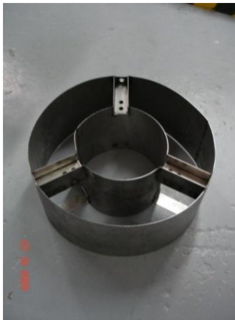
Imagen 5.1 Esqueleto-Formaleta usado para fundir el concreto del montaje experimental.
