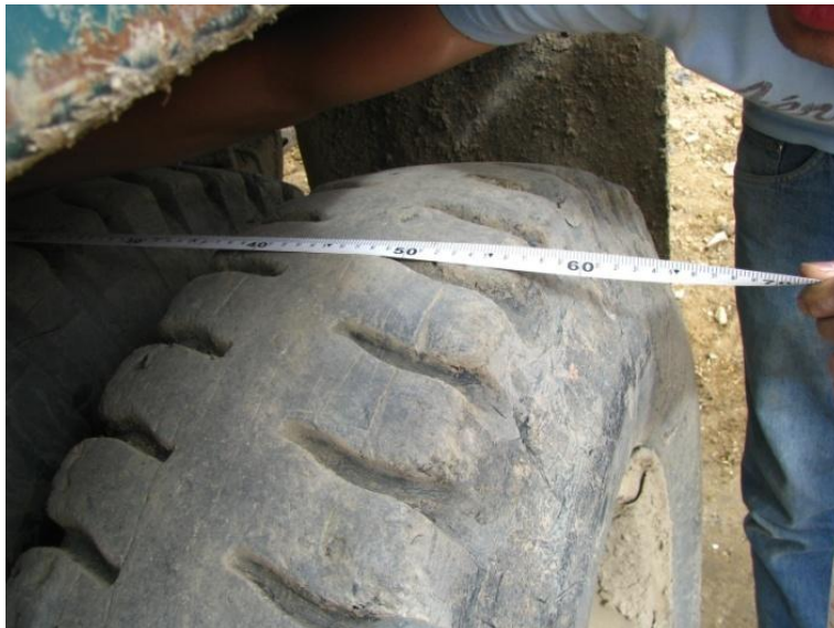
Imagen 8.15: Medición de la dimensión B de la pisada de la rueda.
