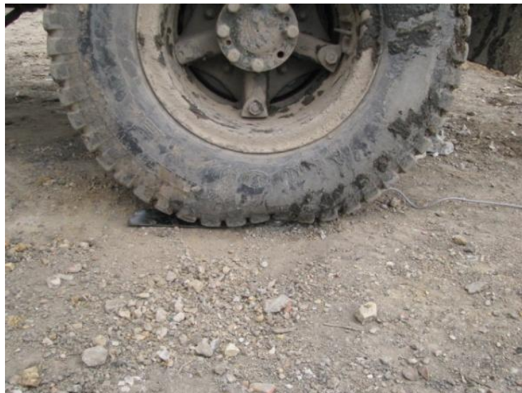
Imagen 8.9: Pesaje de la rueda en el pistón de carga.
