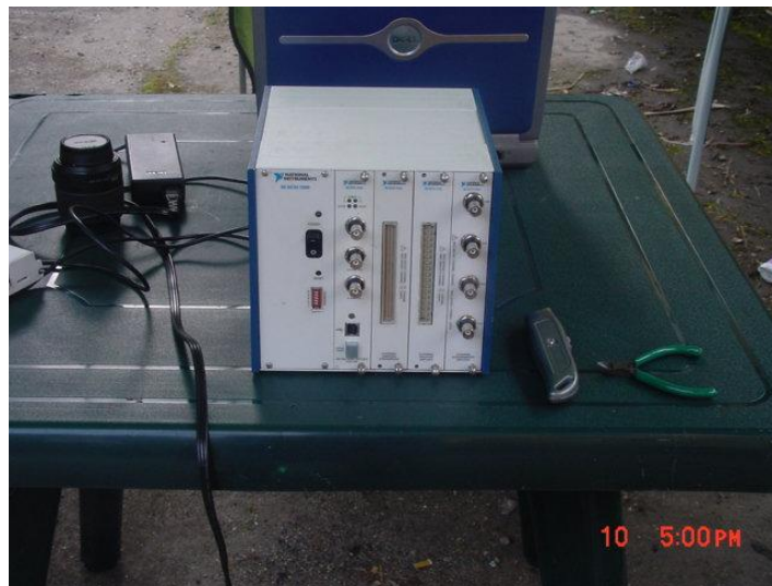
Imagen 6.3: Adquisidor de datos: NI-SCXI-1000 [14].
