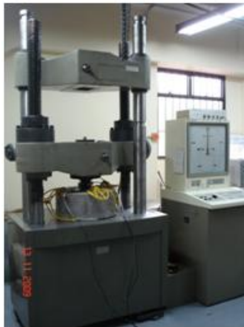
Imagen 7.6: Montaje sobre la Maquina Universal.
