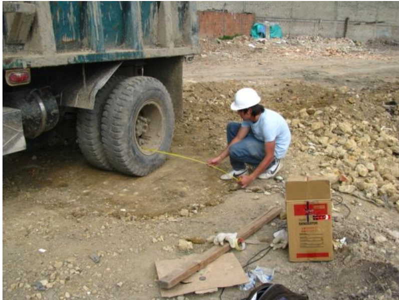
Imagen 8.10: Rectificación de la ubicación de la rueda doble sobre relleno.
