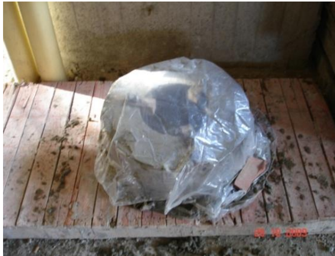
Imagen 5.6: Anillo envuelto con polietileno para su curado.
