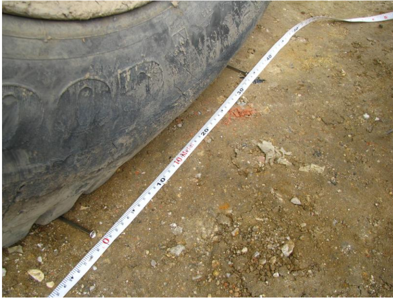
Imagen 8.14: Medición de la dimensión A de la pisada de la rueda.
