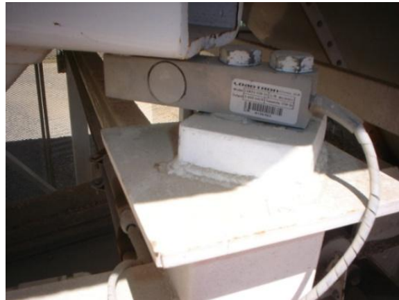
Imagen 5.3: Mecanismo de trabajo en voladizo de una Celda de Carga tipo LOADTRON.
