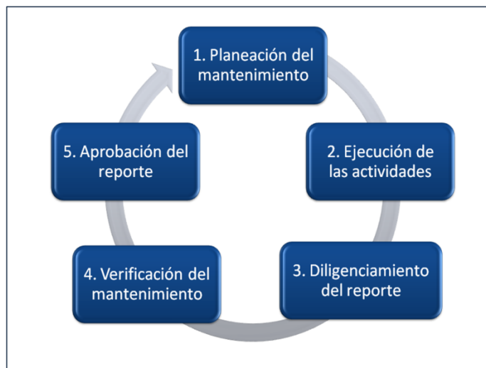
Figura 38. Proceso de ejecución del Mantenimiento Interno
