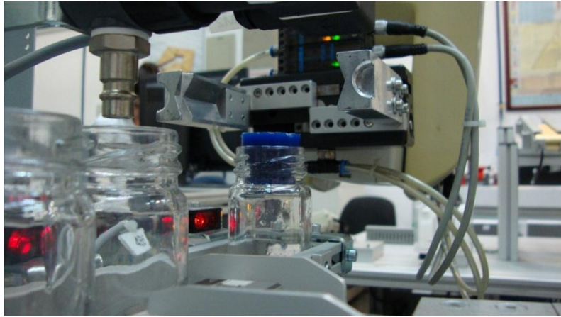
Ilustración 40. Sellado en Banda Transportadora estación MPS®PA de llenado.
