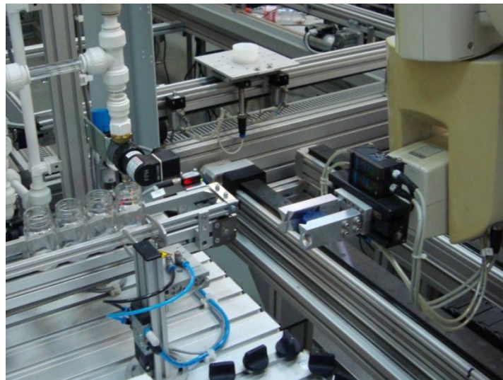
Ilustración 39. Recogida de dispositivo de Sellado.
