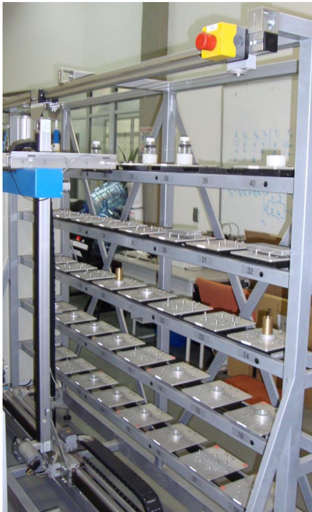
Ilustración 3. Almacén AS/RS del CIM.
