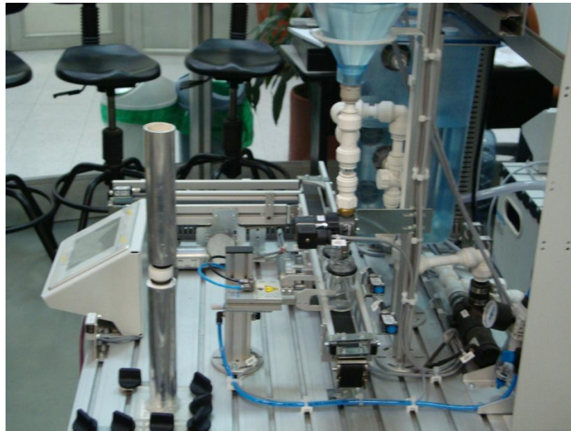
Ilustración 19. Dispensador de Tapas en la Estación MPS®PA de Llenado.
