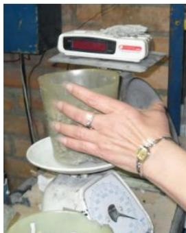
Figura 8: Pesaje del Caucho para la suela.
