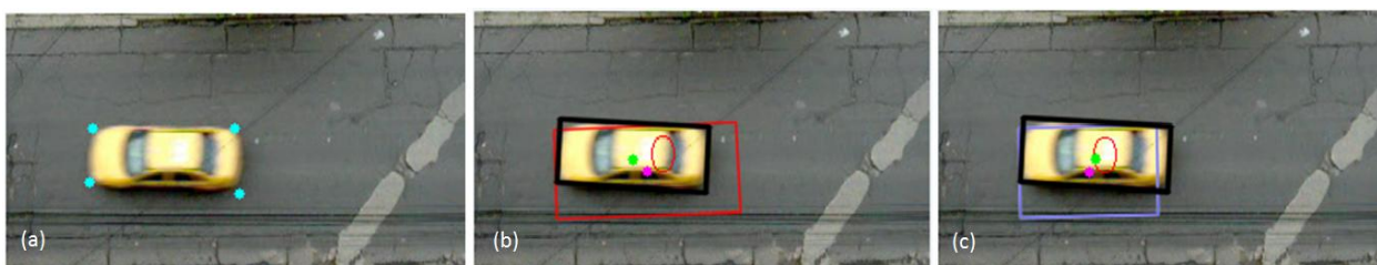
Figura 32. Evaluación de los algoritmos. (a) Selección manual de 4 puntos sobre el objeto, (b) solución Algoritmo 1, (c) solución Algoritmo 2.
