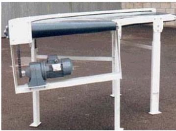
El transporte se realiza mediante el deslizamiento de una banda de PVC sobre el bastidor. Este modelo siempre será accionado mediante un moto-reductor, siendo la transmisión por cadena al tambor motriz.
